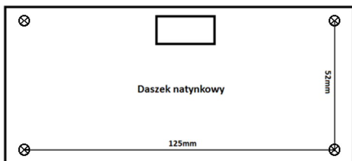
Obr. 1 Rozteč montážních otvorů panelu včetně vrchlíku pro povrchovou montáž. Průměr otvoru: 5 mm
